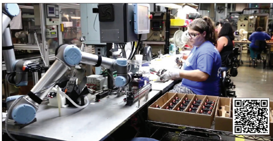
Obr. 2. Ve firmě Scott Fetzer Electrical Group pomáhají kolaborativní roboty v lisovně při výrobě elektromotorů (foto: UR , video: https://youtu.be/-bFgAvCDFqI )
