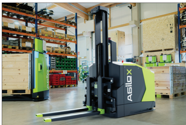
Obr. 2. Inteligentní autonomní automaticky naváděný všesměrový čelní vysokozdvíhací vozík OCF firmy Agilox
