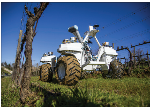
Obr. 2. AgroBot při inspekční misi ve vinohradu
