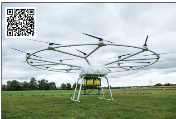
Obr. 1. Ukázkový prototyp dronu VoloDrone vybavený postřikovačem na ochranu plodin (foto: John Deere, video: https://youtu.be/SKmjzPkf_sQ )
