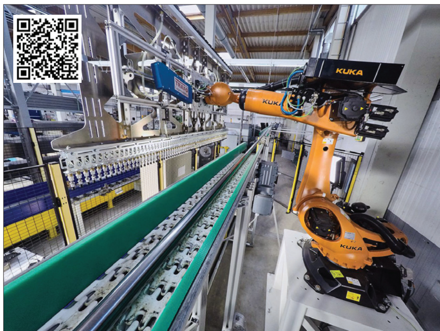
Obr. 1. Zakládání trubek do laserového řezacího stroje (video https://youtu.be/WF4FXwd2j8Q je od firmy Trafö Förderanlagen)
