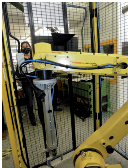
Obr. 2. Jeden z robotů Fanuc M-20iA s uchopovačem Schunk zapůjčené na montážní linku filtrů
