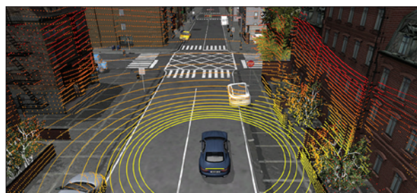
Obr. 2. dSPACE poskytuje vývojářům vysoce výkonné simulační prostředí, pomocí kterého mohou být validovány systémy senzorů (např. zde lidar) jednoduše při simulaci hardware-in-the-loop, virtuálně jako model-in-the-loop, nebo dokonce na základě cloudového řešení jako software-in-the-loop
