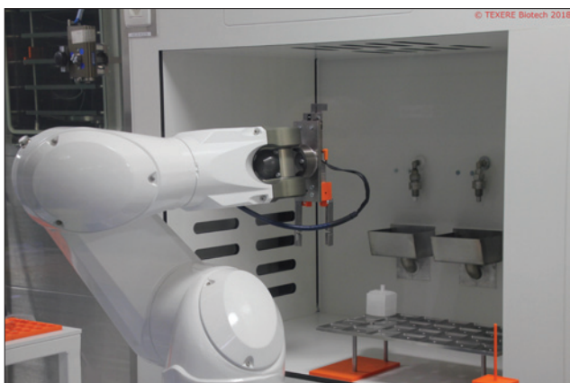
Obr. 4. Jeden ze šesti identických robotů Stericlean od firmy Stäubli ve sterilizační stanici výrobní linky
