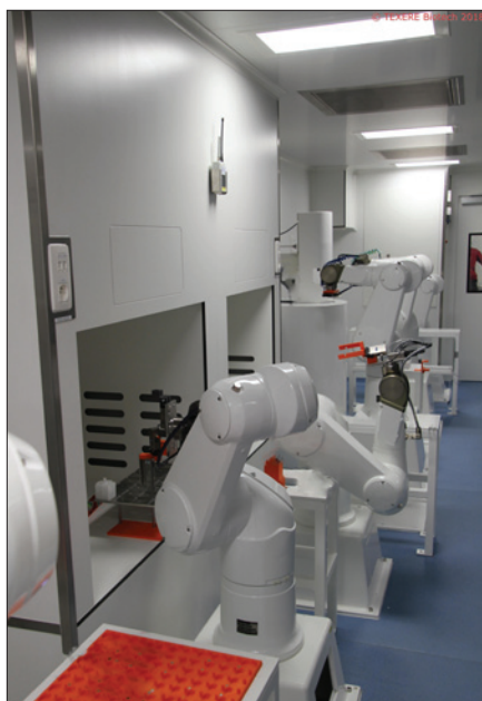
Obr. 1. Výroba probíhá v čistém prostoru vytvořeném ve 12m kontejneru a je certifikována podle GMP
