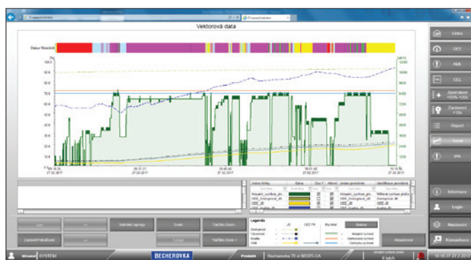
Obr. 4. Přehledné zobrazení závislosti na čase v obrazovce trendu, která byla vytvořena pomocí šablony (faceplate) systému zenon
