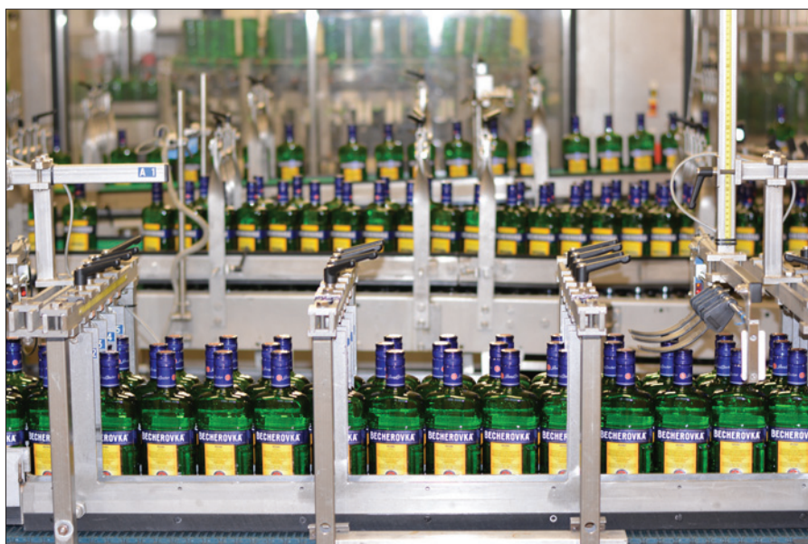
Obr. 1. Automatizovaná plnicí linka v závodě Karlovarská Becherovka – Jan Becher
