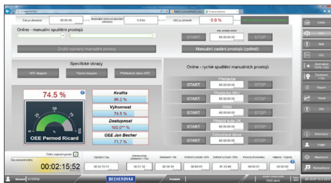
Obr. 3. Nepřetržitý přístup k aktuálním hodnotám OEE, získaným bez nutnosti ručních vstupů, je ve výrobním provozu z panelu chráněného RFID čipem i online prostřednictvím webových klientů
