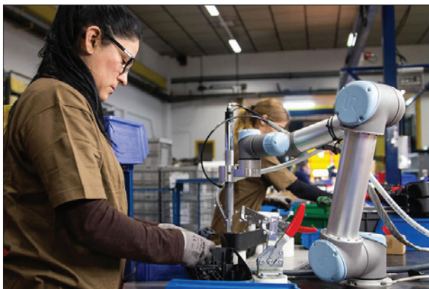
Obr. 2. Kolaborativní roboty na výrobní lince pomohly mnoha zákazníkům Universal Robots vyřešit otázky nedostatku pracovní síly – zde lze vidět spolupráci s robotem v SHAD ve Španělsku, kde robot asistuje pracovnícím při sestavování příslušenství pro motocykly
