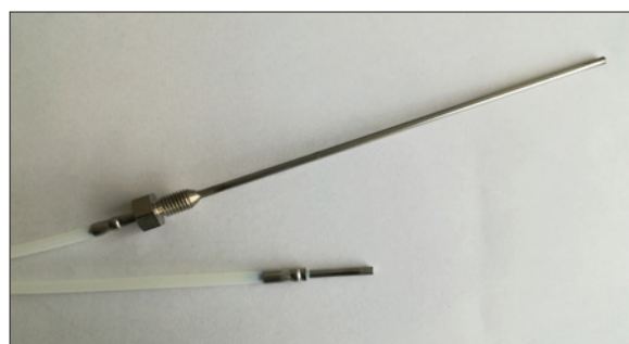
Obr. 6. Ukázka senzorů teploty v pouzdech z korozi vzdorné oceli
