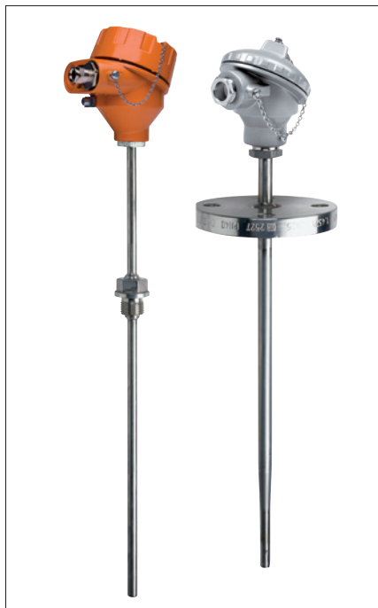
Obr. 1. Odporové snímače TWL, určené do prostředí s nebezpečím výbuchu: vlevo v pevném závěru Ex d, vpravo v jiskrově bezpečném provedení Ex ia
