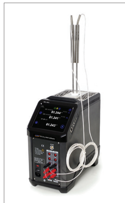
Obr. 2. Suchá kalibrační píčka Additel ADT875, kde se právě automaticky kalibrují dva snímače RTD
