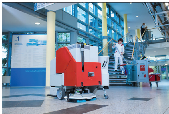
Obr. 1. Úklidový robot s modulem pro mokré čištění při ověřovacích zkouškách v reálném prostředí v nemocnici (foto: Dussmann Group/Kay Herschelmann)
