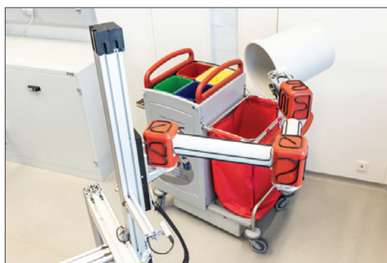
Obr. 2. Úklidový robot vybavený robotickým ramenem samostatně rozpozná koš na papír, uchopí jej a jeho obsah vysype do sběrného zásobníku (foto: Fraunhofer IPA/Rainer Bez)
