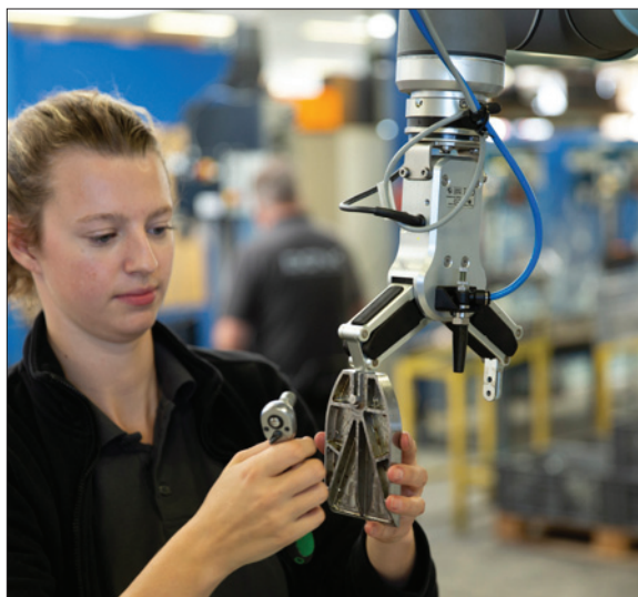
Obr. 2. Obsluha vyměňuje prsty uchopovače RG6
