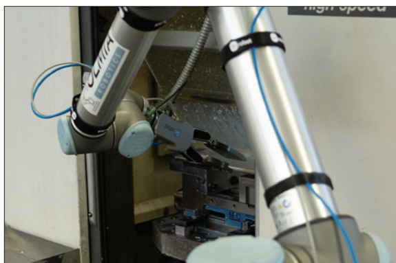
Obr. 1. Robot UR zakládá polotovary do vertikálního obráběcího centra Chiron
