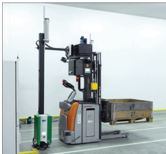
Obr. 1. Automaticky naváděný vysokozdvížný vozík Movanis vzniká doplněním běžného vysokozdvížného vozíku snímači a řídicím počítačem
