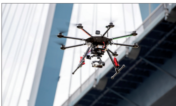
Obr. 1. Při demonstraci svých schopností oblévají autonomní drony most po různých letových trajektoriích (foto: DLR)
