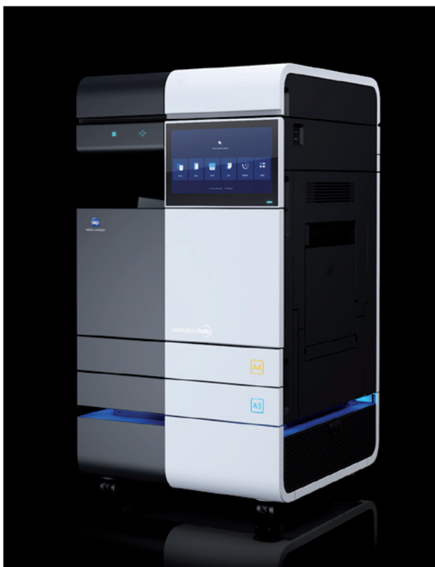
Obr. 1. Workplace Hub s integrovanou A3-multifunkcí nahradí tisíckárnu, kopírku, router wifi, datový server, úložiště i zabezpečení dat
