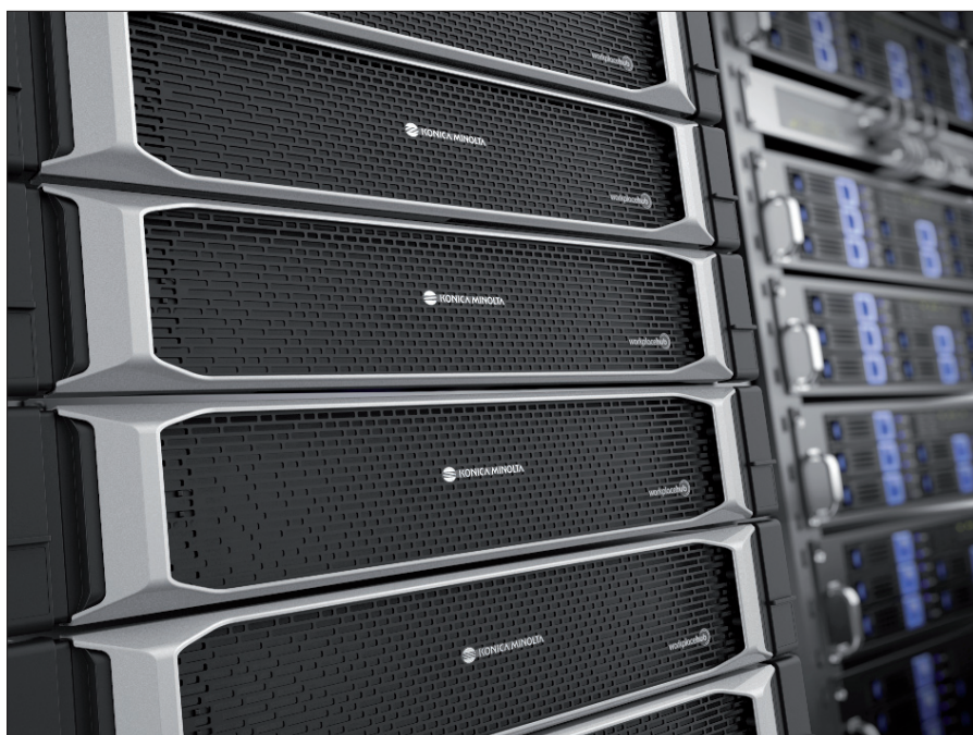
Obr. 2. Workplace Edge – varianta určená k montáži do racku v serverovně
