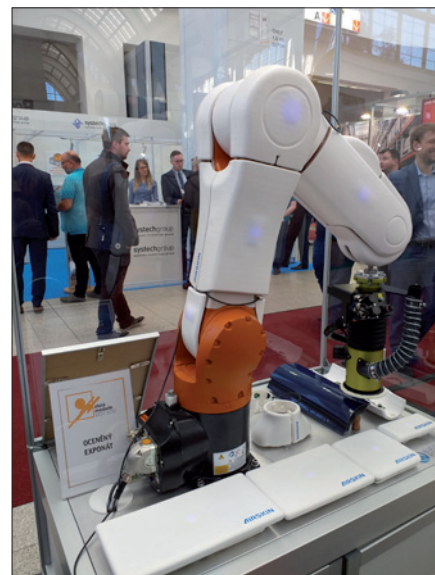
Obr. 2. Bezpečnostní opláštění Airskin na průmyslovém robotu
