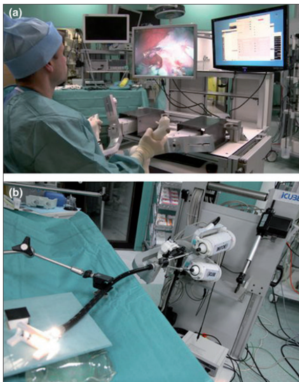
Obr. 5. Externí uspořádání systému ISIS-Scope/STRAS
