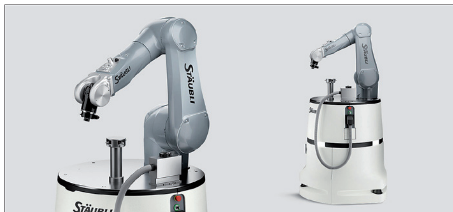
Obr. 1. Mobilní autonomní a kolaborativní roboty HelMo od firmy Stäubli
