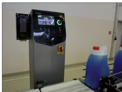
Obr. 3. Na průběžné kontrolní váze se ověřuje správné naplnění lahví
