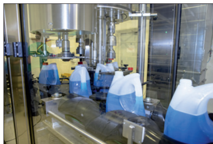
Obr. 2. Automatický zavírací stroj Hermes opatří lahve šroubovacím uzávěrem
