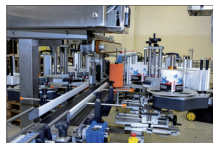
Obr. 4. Zdvojené etiketovací jednotky zajišťují plynulost automatického plnění
