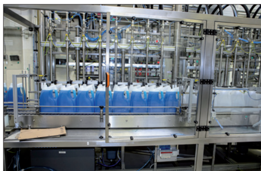
Obr. 1. Lineární plnicí stroj Polaris plní vždy šestnáct lahví současně
