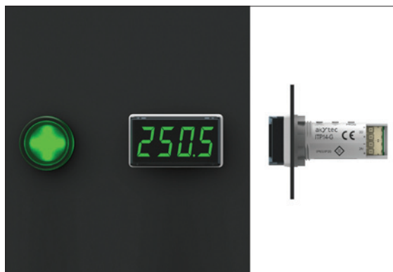
Obr. 2. Zobrazovače se montují do otvoru o průměru 22,5 mm, stejně jako jiné standardní ovládací prvky
