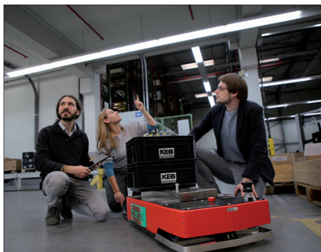
Obr. 2. Dopravní vozík bez řidiče využívající k navigaci modulované světlo stropních svítidel (foto: Fraunhofer IEM)
