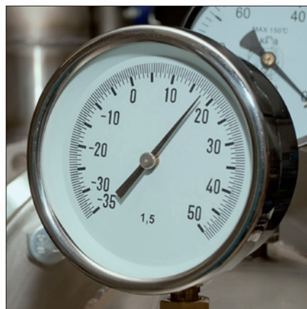
Obr. 3. K přesnému přečtení údaje ručičkového tlakoměru je důležité dívat se na číselník přístroje z kolmého směru
