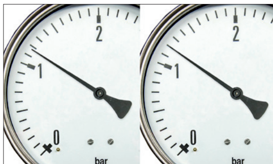
Obr. 2. Údaj tlakoměru zobrazeného vlevo není snadné přečíst úplně přesně, protože jeho ukazatel se nachází mezi značkami na stupnici; naproti tomu údaj tlakoměru napravo, jehož vstupní tlak je nastaven tak, že ukazatel je v koincidenci se značkou stupnice, je jednoznačný
