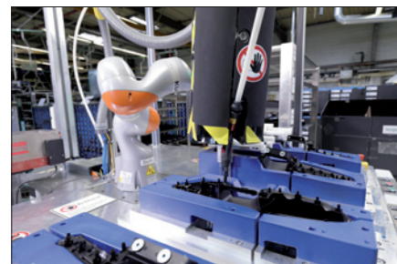
Obr. 2. Bezpečný robot nestačí, bezpečné musí být celé pracoviště – robot nese šroubovací hlavu vybavenou bezpečnostními prvky (vpředu je dobře vidět hadice přivádějící šrouby)
