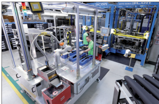
Obr. 1. Robot LBR iiwa na pracovišti montáže loketních opěrek v závodě firmy YFAI
