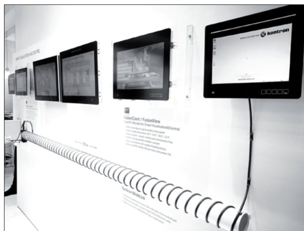
Obr. 2. WideLink zajišťuje datovou komunikaci mezi vzdálenými vizualizačními jednotkami a řídicím počítačem prostřednictvím ethernetového kabelu na vzdálenost až 100 m
