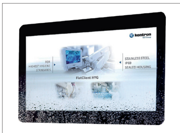
Obr. 5. Panelový počítač FlatClient HYG je navržen ve shodě s doporučeními EHEDG (European Hygienic Engineering and Design Group) a má nejvyšší třídu krytí, IP69K
