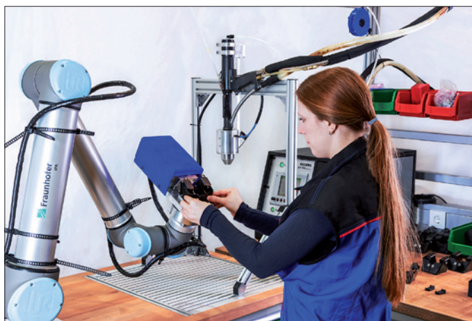
Obr. 1. Člověk a robot mohou těsně spolupracovat – zde např. při operaci nýtování (foto: Fraunhofer IPA, Rainer Bez)
