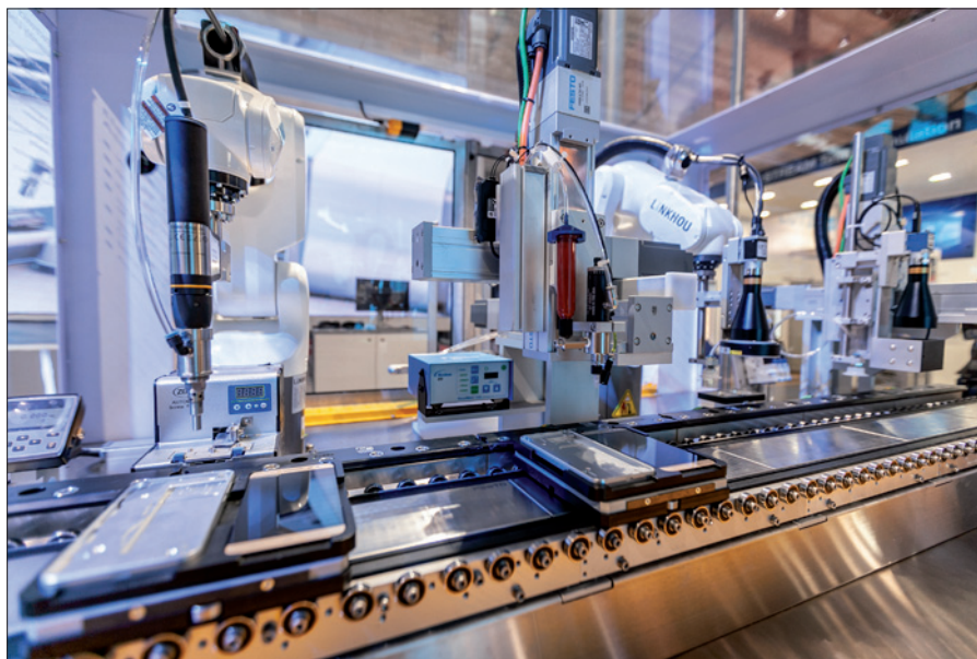
Obr. 1. Montážní stroj pro chytré telefony od společnosti Bozhon, u kterého bylo od návrhu po zprovoznění využito digitální dvojče v prostředí Siemens TIA Portal
