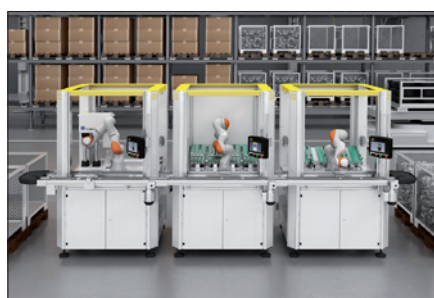
Obr. 5. Modulární sestava výrobní linky vyžaduje inteligentní kabeláž a oboustrannou komunikaci s řídicím systémem provozu, logistiky i servisu (Harting)
