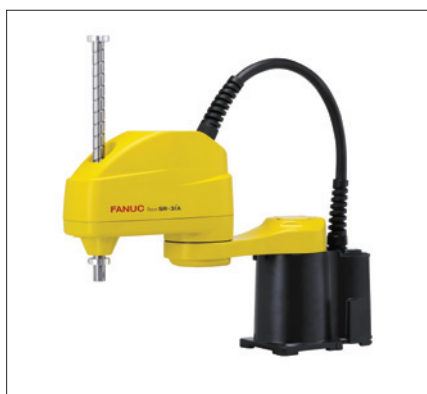
Obr. 3. Lehký kompaktní robot SCARA zvládne rychlé pracovní operace (Fanuc)
