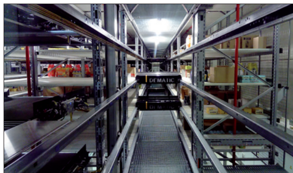
Obr. 2. Skladový systém společnosti Dematic pro rychlé uskladňování a vychystávání zboží
