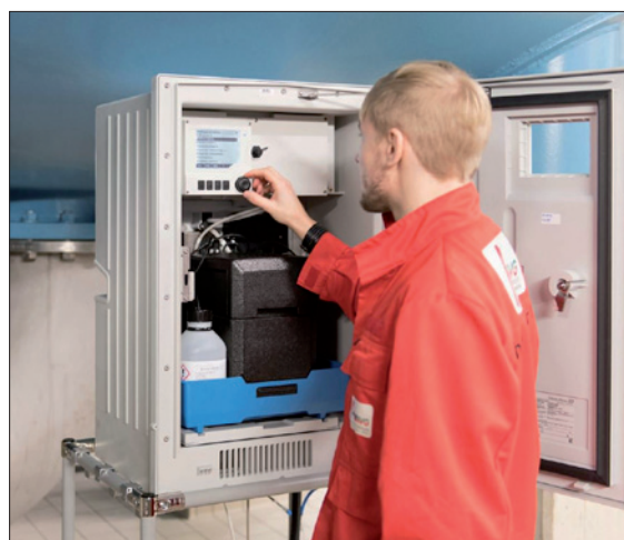
Obr. 2. Analyzátor koncentrace ortofosfátů ve vodě CA80PH
