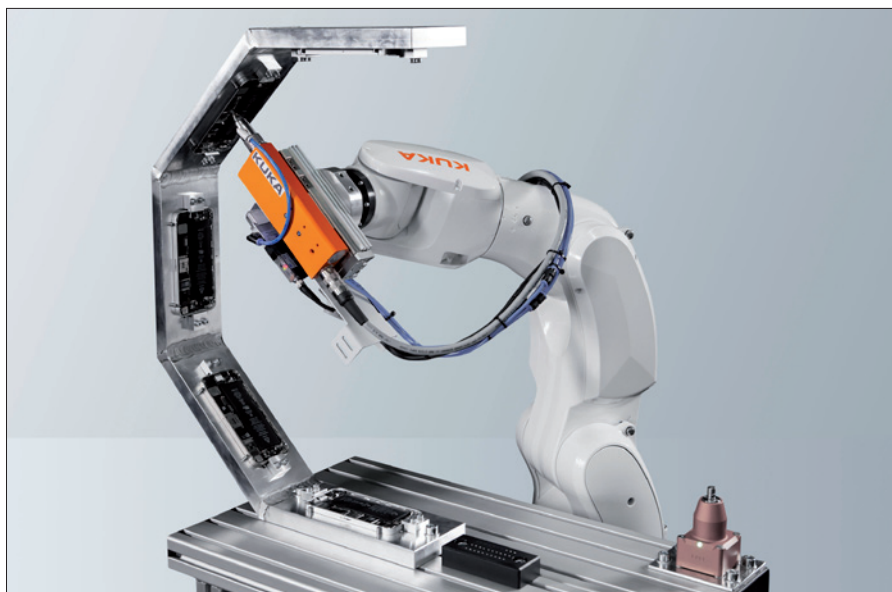
Obr. 4. Balíček Ready2 Fasten Micro je určen k robotickému utahování malých šroubků
