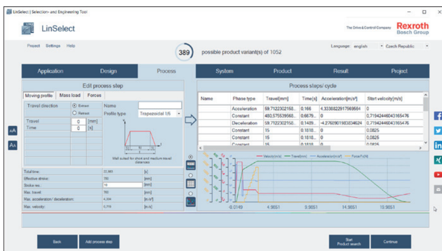
Obr. 4. Volně dostupná aplikace LinSelect je určena pro výběr lineárních pohonů ze sortimentu Bosch Rexroth
