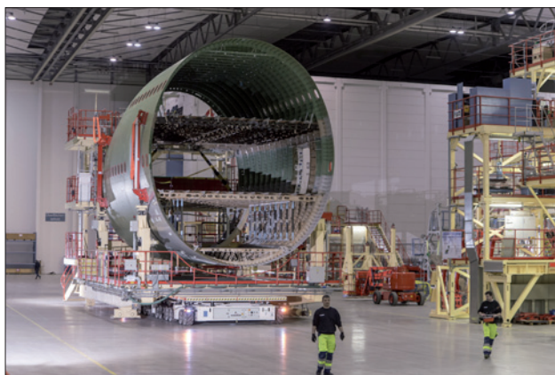
Obr. 1. Robotická platforma OmniMove našla uplatnění při výrobě letadel Airbus A380 (více na https://youtu.be/RZ_8xhCi72w )
