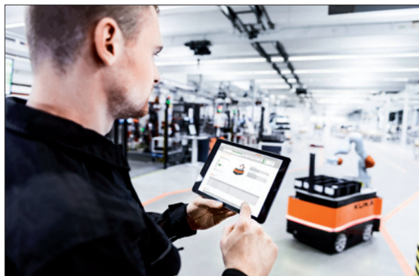
Obr. 3. Robot KMR iiwa se může pohybovat autonomně nebo může být ovládán operátorem např. pomocí tabletu
