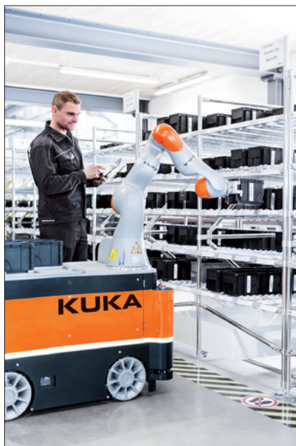
Obr. 2. Mobilní robot KMR iiwa je vhodným řešením pro vychystávání zboží ve vysoce automatizované malosériové výrobě
