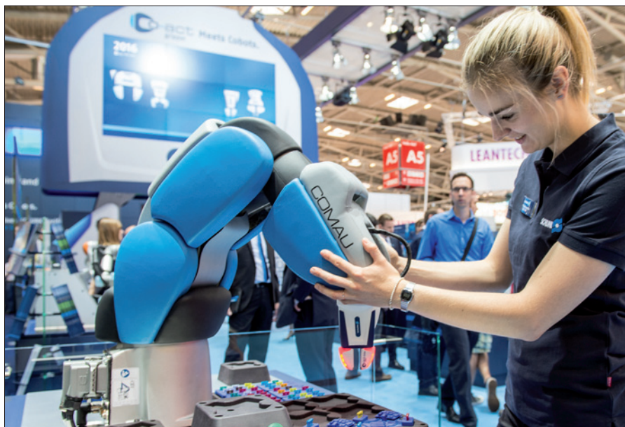
Obr. 1. Výrazným tématem minulého ročníku veletrhu Automatica byly kolaborativní roboty (na obrázku je chapadlo Co-act od firmy Schunk na robotickém rameni AURA od firmy Comau)
