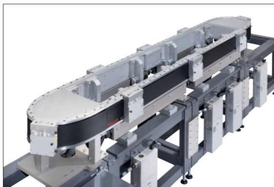
Obr. 1. Dopravník Bosch Rexroth Active Mover pro autonomní dopravu palet
