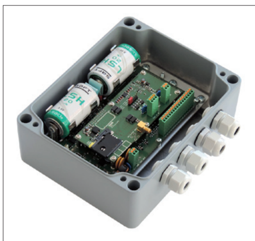
Obr. 1. RTU7B – jednotka RTU vybavená bateriovým napájením (víko demontováno)
