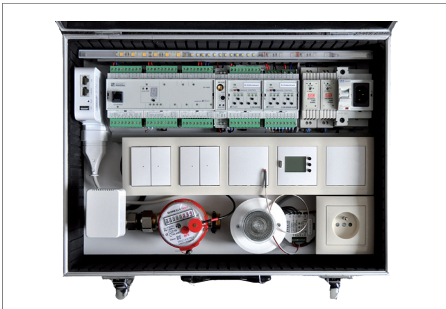
Obr. 2. V laboratořích bývá Tecomat Foxtrot kompletován spolu s příslušenstvím do složitějších celků – zde do výukového kufríku (v případě potřeby lze desku s přístroji z kufríku vyjmout)
