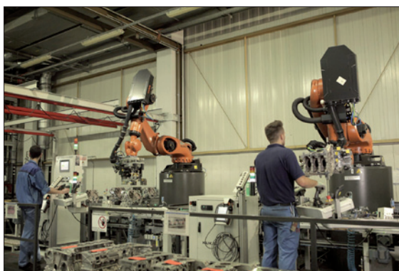
Obr. 1. Dva konzolové roboty KUKA KR 210 R2900 prime K z řady KR Quantec ve společnosti BMW v Landshutu umožňují optimální kontrolu kvality skříní klikových hřídelí
