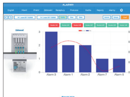
Obr. 3. Přehled historie poruch zařízení
