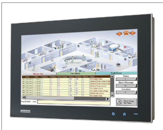
Obr. 2. Průmyslový počítač TPC – pohled z čelní strany
