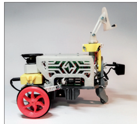
Obr. 3. Mobilní robot Foxee – hračka s PLC Tecomat
