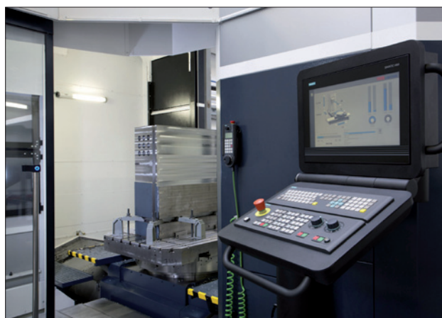
Obr. 2. Pracoviště obsluhy je vybaveno operátorským panelem se systémem TOS Control
