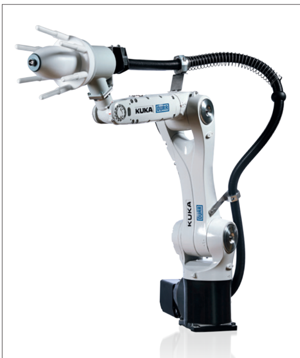
Obr. 1. Lakovací robot ready2_spray je společným produktem firem KUKA a Dürr (foto: Kuka)
