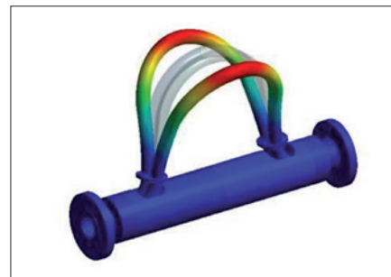
Obr. 3. Vyvážené kmitání trubic simulované metodou FEM
