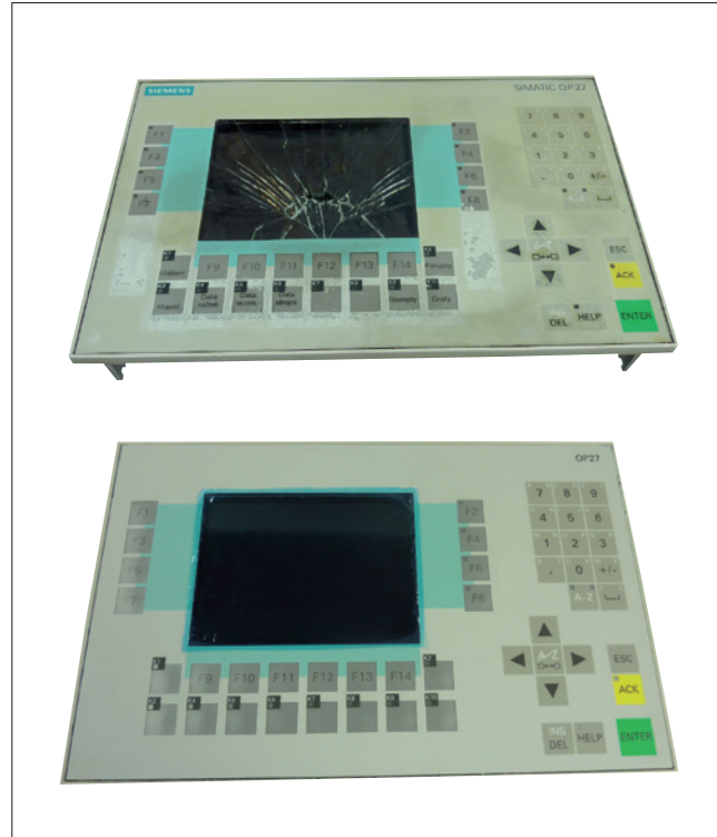
Obr. 2. Operátorský panel od firmy Siemens před repasí a po ní
