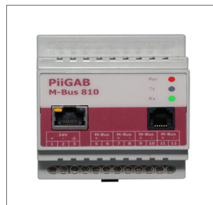
Obr. 3. Převodník PiiGAB 810 převádí M-Bus na Ethernet a umožňuje odečet spotřeby přes internet
