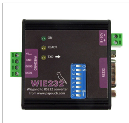
Obr. 1. Převodník WIE232 převádí Wiegand na RS-232
