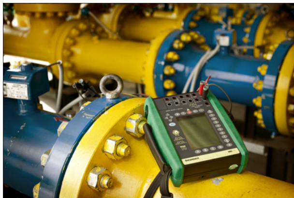
Obr. 2. Komunikátor HART typu Beamex MC5-IS lze použít v prostředí s nebezpečím výbuchu
