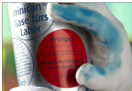
Obr. 1. Senzorická rukavice se v přítomnosti nebezpečné látky zbarví domodra (foto: Fraunhofer EMFT)
